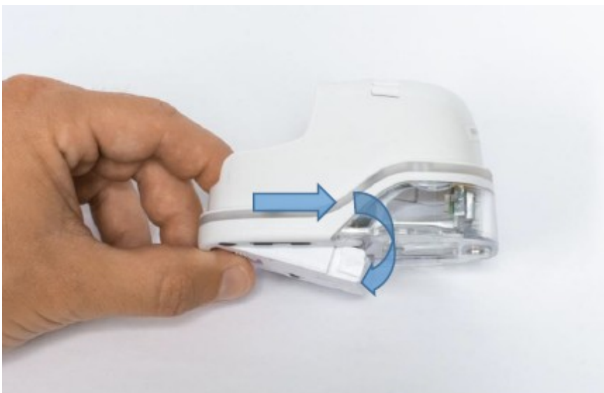
Rys.44: Komora przesuwna otwarta
